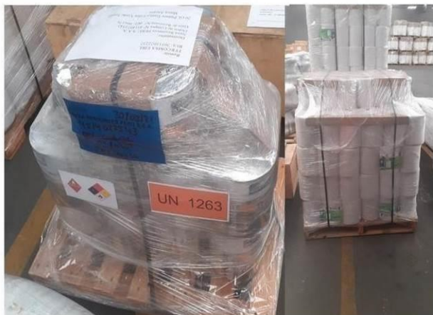
Material acondicionado de manera correcta.
